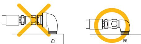
適切なアダプタ類を選定する事により、接続個所を減らし気密の信頼性、外観の向上がはかれます。
